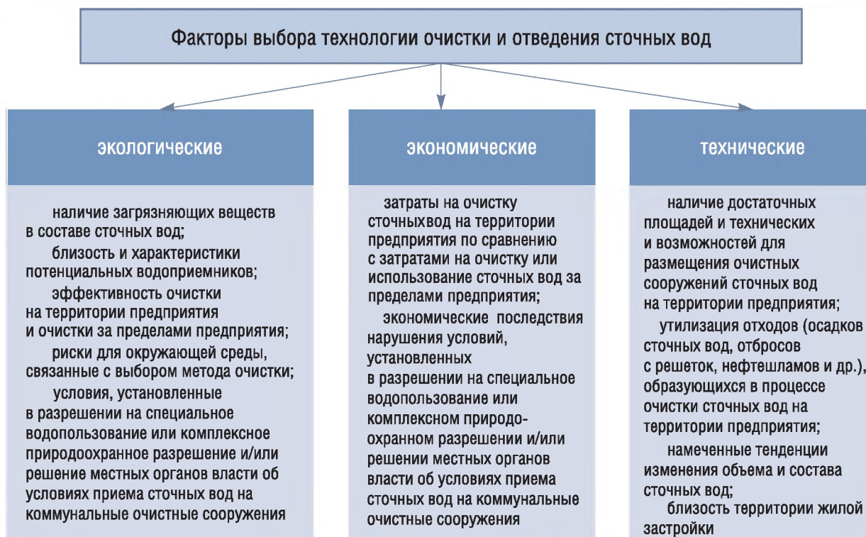
Рис. 3. Факторы выбора технологии очистки сточных вод
